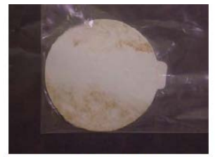
1号機X-2ペネ堆積物除去治具のスミヤ外観 (直径約5cm)
