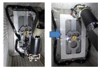
図2 インプレートシール要素試験
